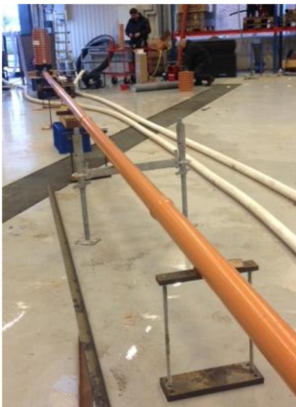
Foto 4. Prøveopstilling til test af enkelttab.
